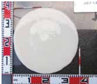
▲A液フロー値 〈製造直後 350×350mm〉
