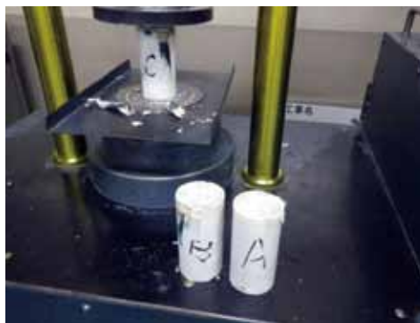
▲一軸圧縮試験供試体： \phi 50 \text{ mm} \times 100 \text{ mm}
