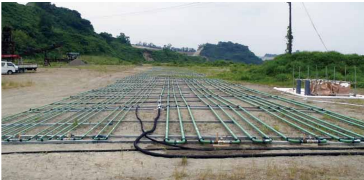
▲2,000m長距離圧送試験状況
